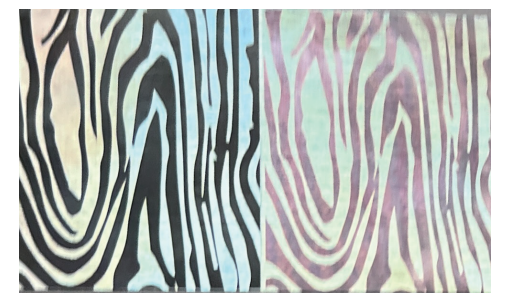
木目の印刷の実験 かなりの板厚があるも、青色から金色へ板が 反って色が変わってしまった（左側）
